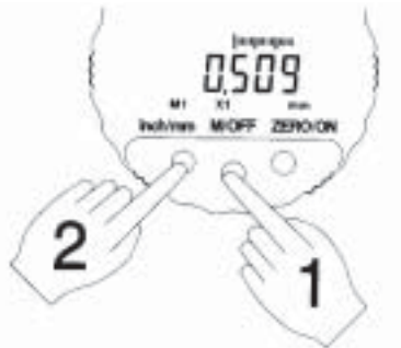
Abb. 5.2a Wechsel der Analogvergrößerung
