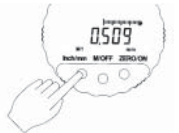
Abb. 5.2b Wechsel der Analogvergrößerung
