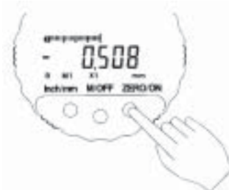
Abb. 5.1b Wechsel der Messrichtung
