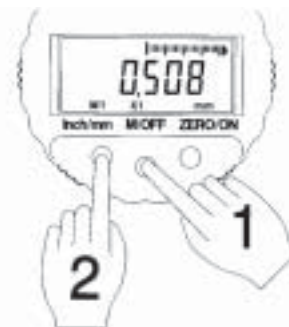
Abb. 5.1a Wechsel der Messrichtung
